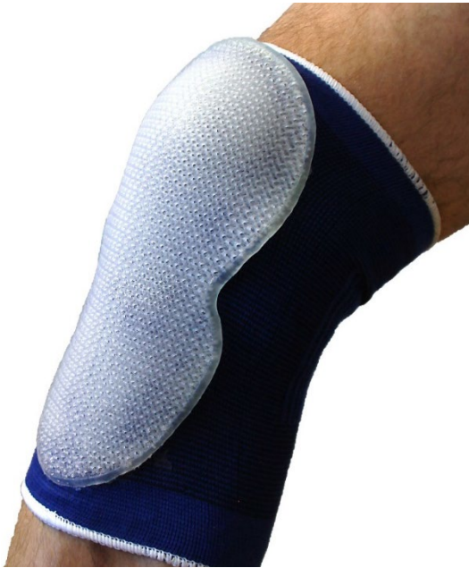
Abb. 4 Redesign eines Knieprotektors. Bei einem Aufprall verteilt die TPMS-Struktur die Energie über die ganze Fläche und entfaltet daher eine bessere Schutzwirkung als Protektoren mit Wabenstruktur oder mit dämpfendem Schaum.
